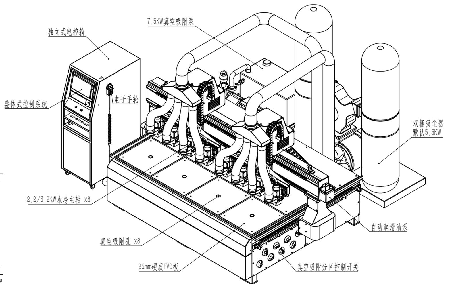
本机型号: HG 2513-2Z8T (HG系列, X轴行程2500mm, Y轴行程1300mm, 2头8主轴, 每个头带四主轴), 本图所示为一套。
