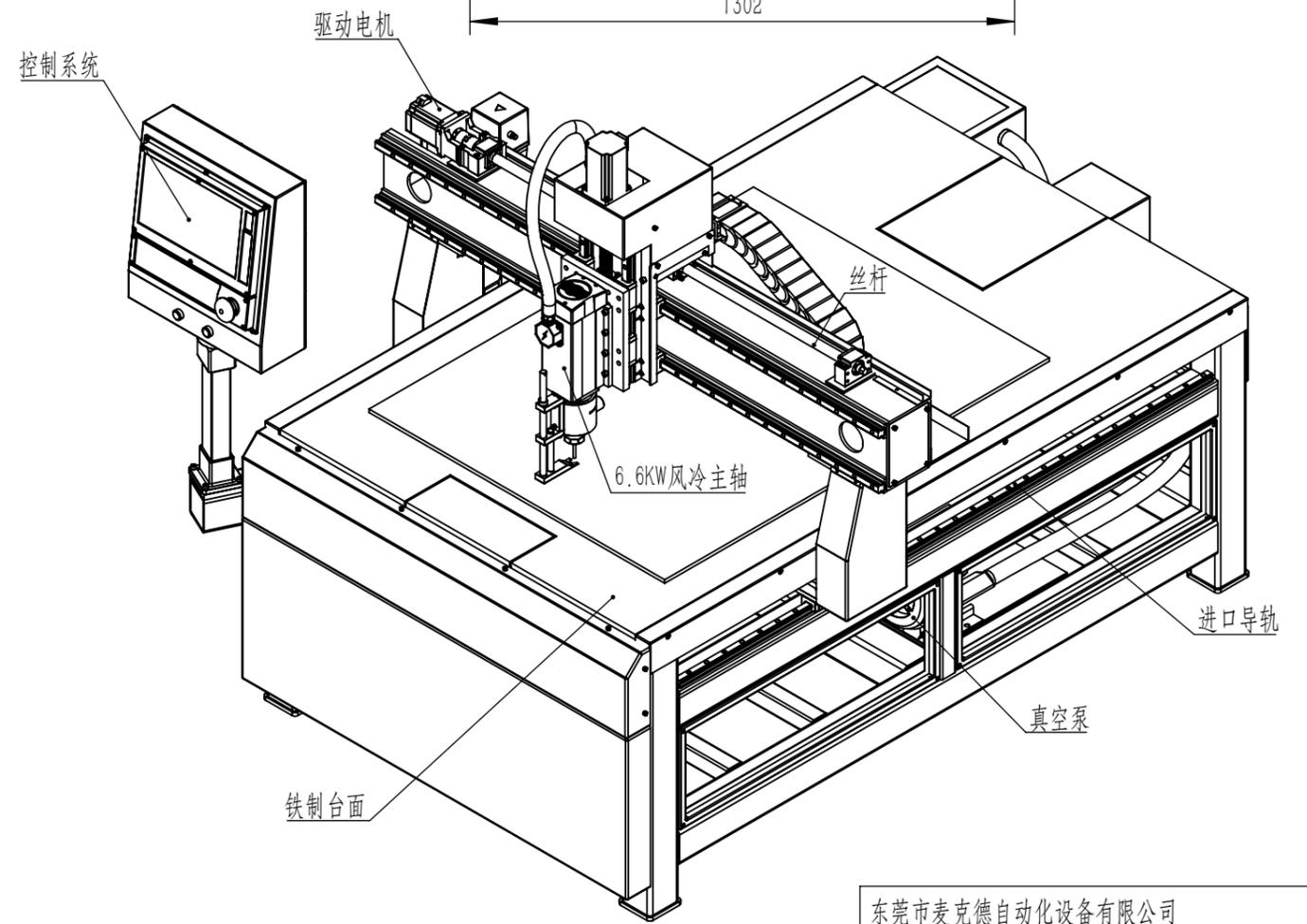
本机型号MKD-1013-H, 或称1013打孔机, X轴行程1米, Y轴行程1.3米。适用于牛皮纸等软质材料打孔。
