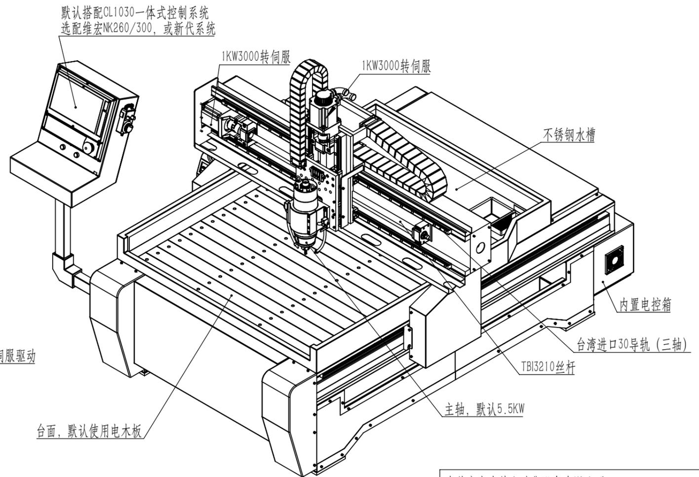
本机型号: MKD-1313-ES, 工程板雕刻机。三轴采用TBI3220/10丝杆驱动, 三轴采用1KW伺服驱动
