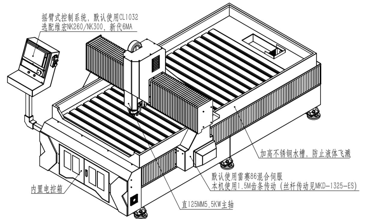
本机型号: MKD-1325-E (V1), 齿条机, 水槽版 (另有压辊版, 真空吸附版)
