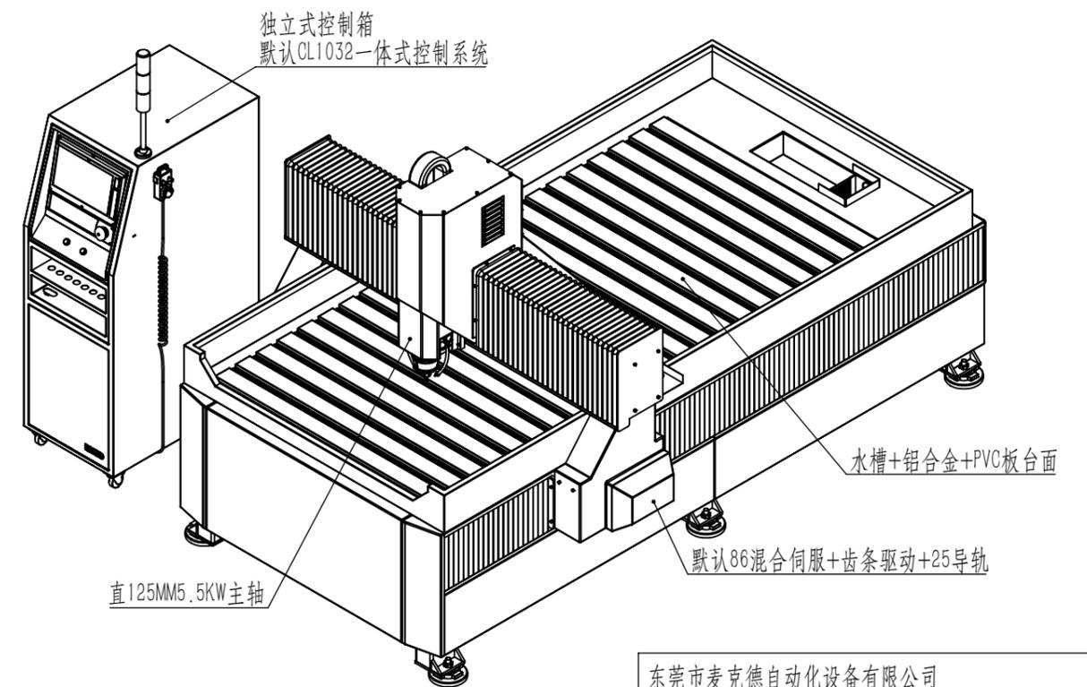
本机型号MKD-1325-E (V2, 带水槽, 齿条驱动, 独立式控制箱。) 本型号有多个版本, 真空吸附版, 压辊版等
