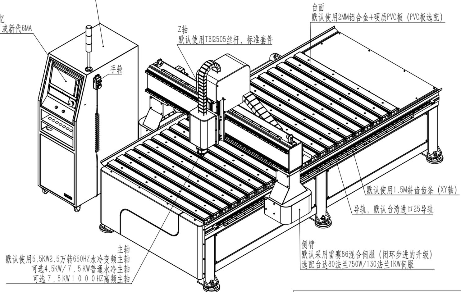
本机型号MKD-1325-E(V4), 第四版, 铝合金台面, 齿条驱动。(本型号有多款配置: 丝杆驱动、真空吸附等)
