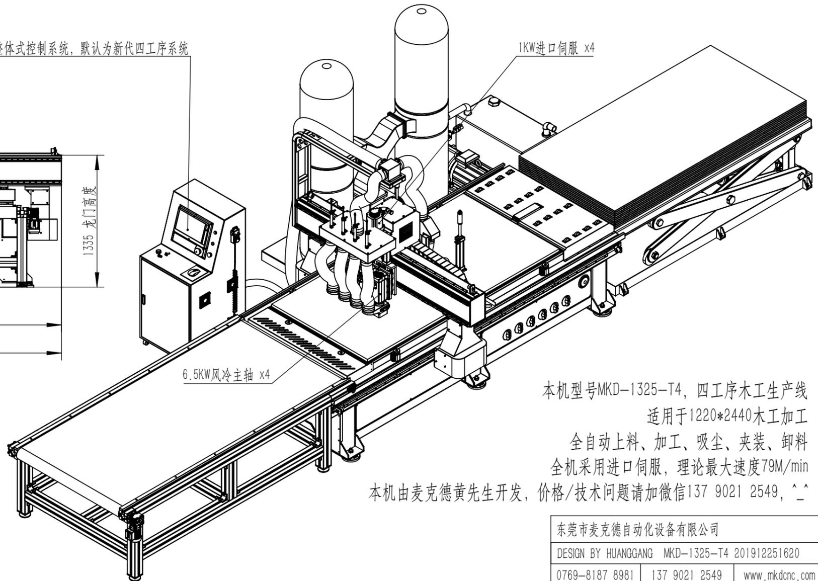
本机型号MKD-1325-T4, 四工序木工生产线
