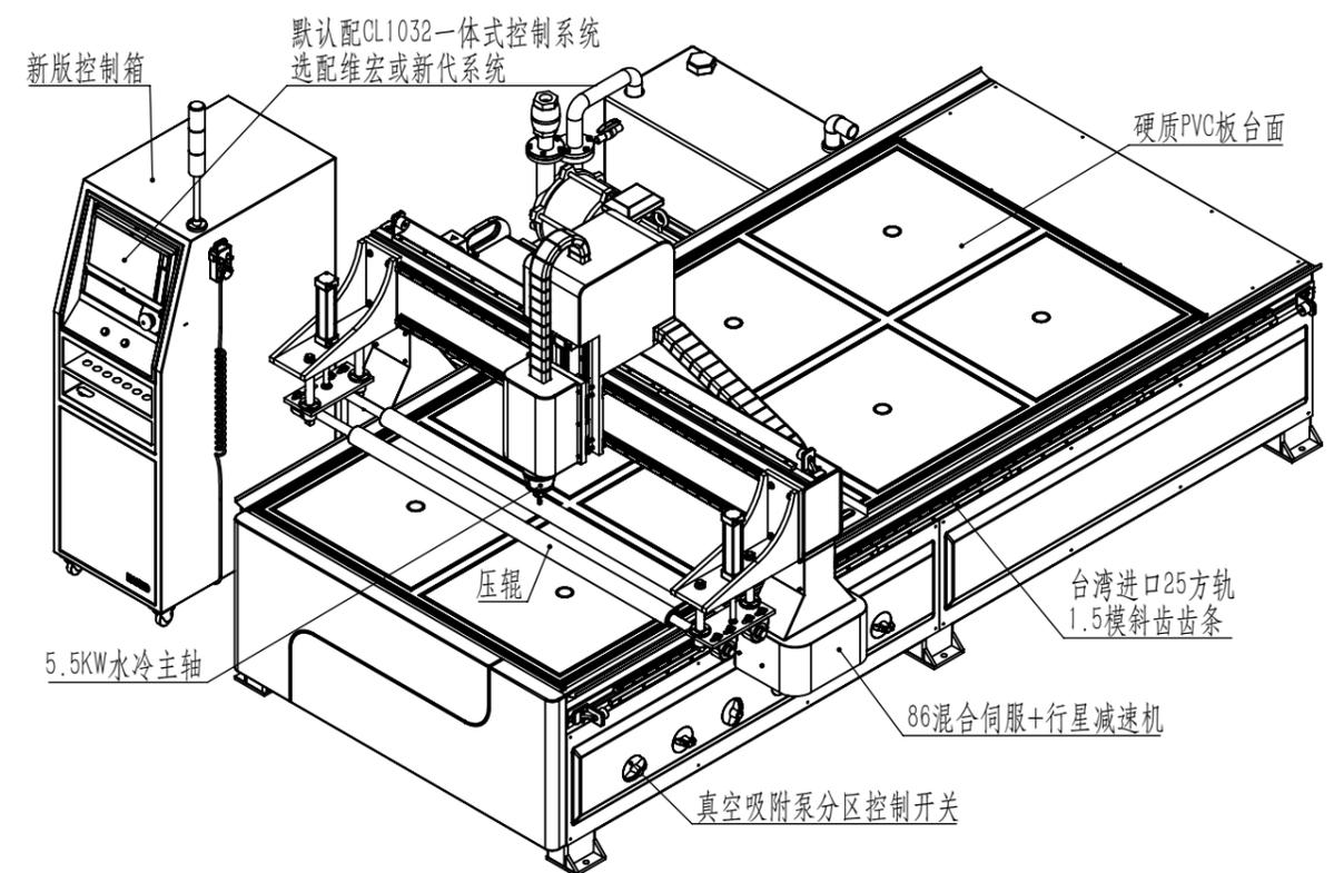
本机型号: MKD-1532-P, 针对非标设备使用的PP/PVC板开料而设计。
