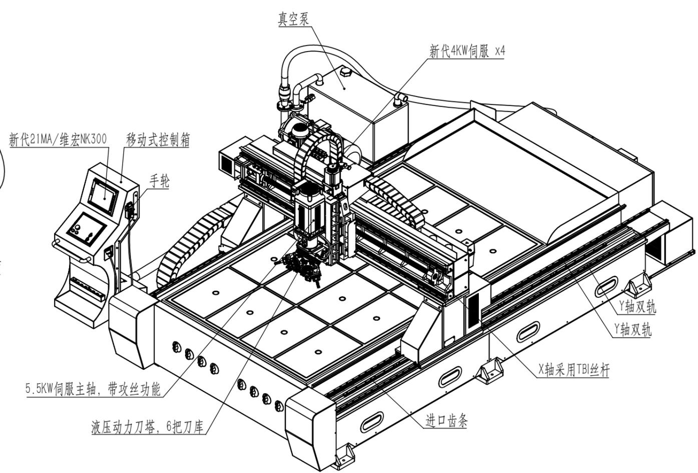
本机型号MKD-1830-SGL, X轴行程1.8米Y轴行程3米。本机采用全伺服驱动, 并且Y轴采用双轨, 提供理好的稳定性。
