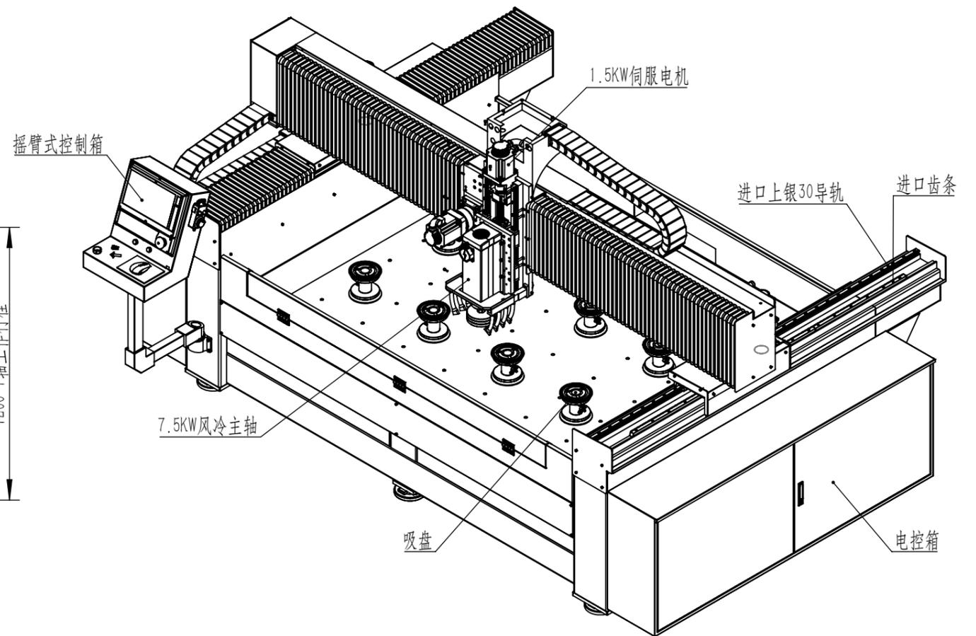
本机型号MKD-2012-BL, 适用于玻璃打磨, 浮雕, 切割等加工。本机三轴采用全伺服驱动。
