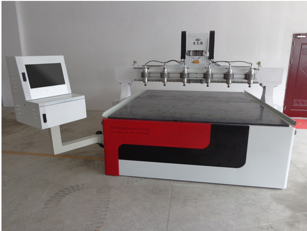
(实拍，图片控制箱为 PCI 控制卡，搭配电脑，标准机型为一体式控制箱，下同)
