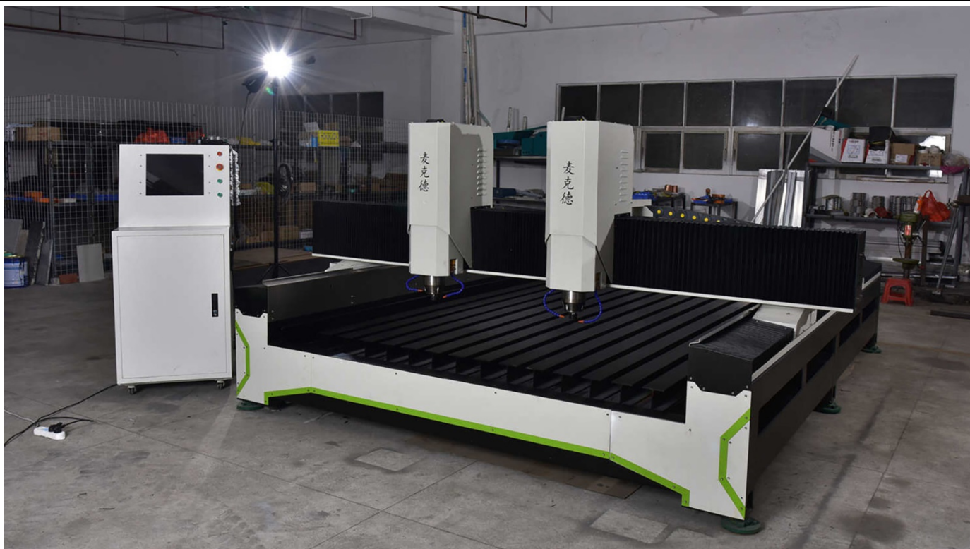
(实拍，图片控制箱为维宏 PCI 控制卡+工控显示器，标准机型为一体式控制箱，下同)
